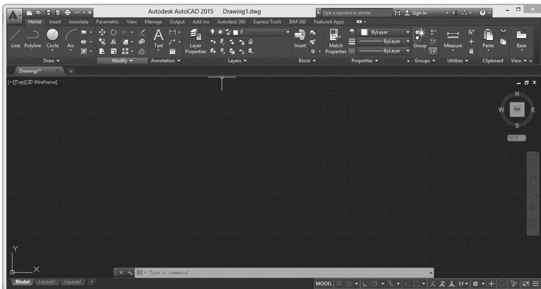
En la parte inferior derecha de la pantalla, tenemos un ícono parecido a un timón, llamado **Workspace Setting**, que nos permite acceder a tres diferentes configuraciones de las herramientas de AutoCAD según sea el diseño a elaborar, es decir, si es un diseño en dos o tres dimensiones.
