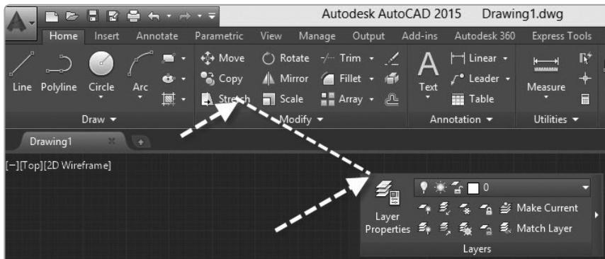
Las cintas pueden ser personalizadas y crear sus propios paneles. Además, se pueden modificar los comandos y los controles de los paneles en cintas existentes. Para crear o modificar un panel de cinta, se usa el editor **CUI (Customize User Interface)**. Cuando se trabaja con paneles de cinta, se pueden crear nuevas filas o subpaneles para organizar los comandos y controles.
