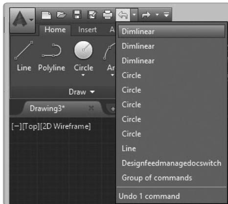
Para agregar más comandos, haga clic derecho sobre la barra **Quick Access** y seleccione **Customize Quick Access Toolbar**. Se muestra el diálogo **Customization User Interface** o **CUI**, y se muestra la lista de comandos posibles. Elija el comando deseado y termine con **OK** o arrastre el comando que desee agregar desde el panel de **Command List** hacia la barra de herramientas **Quick Access**.
